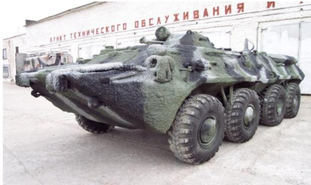
Рис. 1 Внешний вид БТР-80 с нанесенным слоем пенообразующей рецептуры
