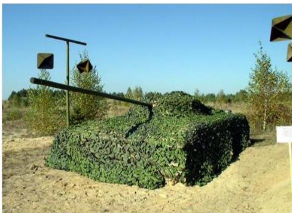
Рис. 1 Имитация техники с применением отражателя металлического уголкового ОМУ.
