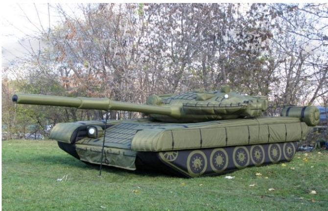
Рис.1 Пневматический макет танка Т-80 - шифр «Инвентарь»
