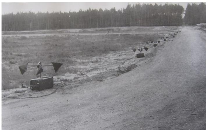
Рис.3 Имитация передвижения военной техники с применением радиолокационных имитаторов движущейся техники
