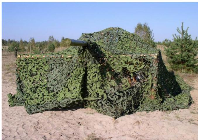
Рис.1 Неподвижный, каркасный макет боевой машины.
