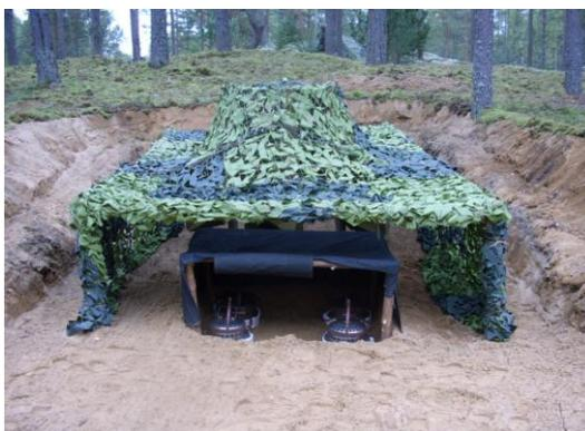
Рис. 1 Макет БМД с использованием табельного маскировочного комплекта и каталитических фитильных печей КФП-1-180
