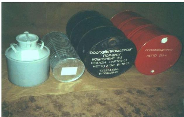
Предназначено для маскировки объектов ВВТ с длительным циклом боевого функционирования (от 10 дней до 6 месяцев), а также на объектах, где к маскирующим материалам предъявляются жесткие требования по массе и габаритам. Формируется на основе наполненных пенополиуретанов методом напыления, как в стационарных, так и в полевых условиях.
