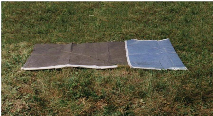
Рис.1 Маскировочное покрытие для скрытия ВВТ от тепловых СР и СНО - «Вихорь-11».
