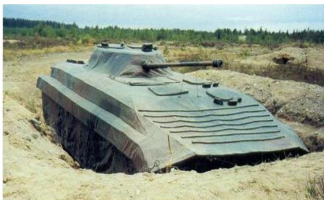
Рис.3 Пневматический макет боевой машины БМП-2.
