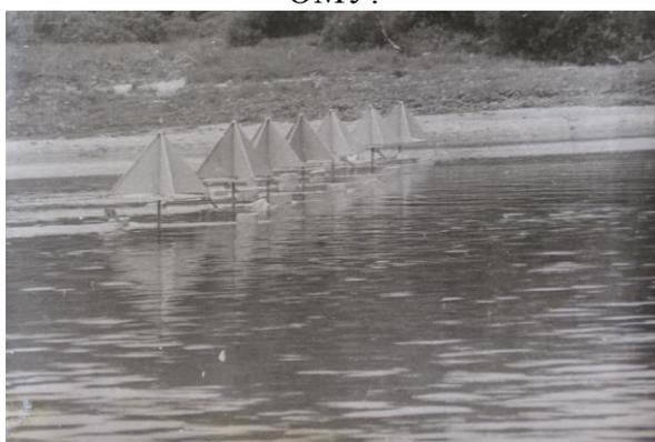
Рис. 3 Имитация мостовой переправы с применением уголковых отражателей «Пирамида»
