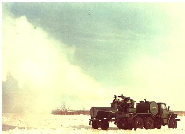
Рис. 3. Постановка аэрозольных завес тепловыми машинами ТМС-65
