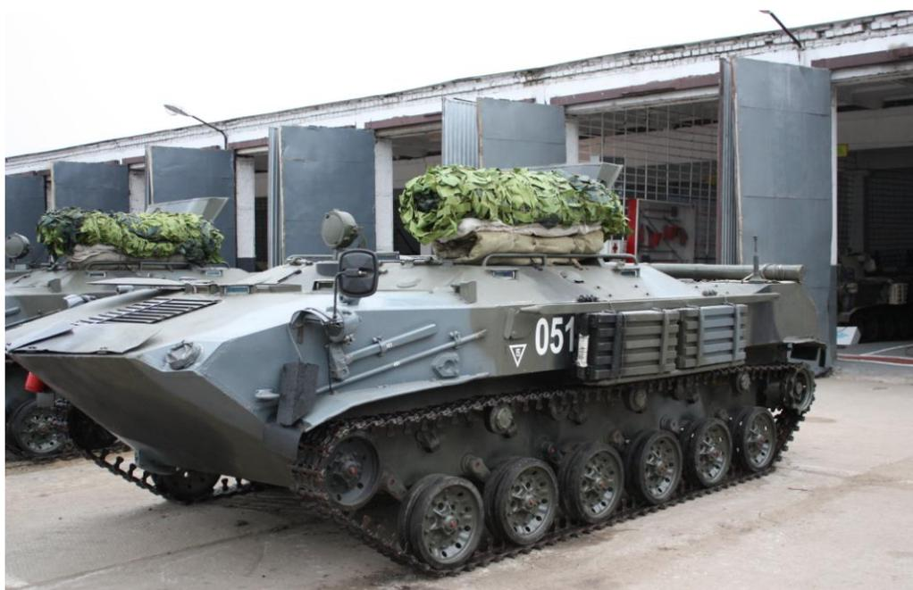
Рис.1 Индивидуальный комплект скрытия и имитации закрепленный на БТР-Д.
